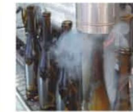
Inertage par azote liquide
